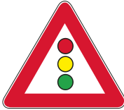
Traffic signals Lichtzeichenanlage
